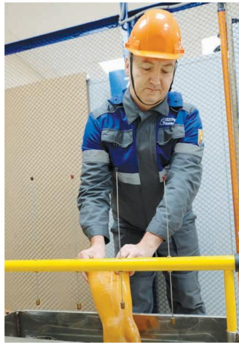
Электромонтёр 6 разряда по ремонту аппаратуры РЗА Сергей Зиберт устанавливает перчатки для проведения испытаний
